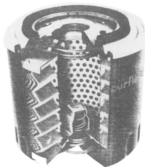
Een opengewerkt model van een oliefilter. Duidelijk is ook de overdrukklep te zien.
