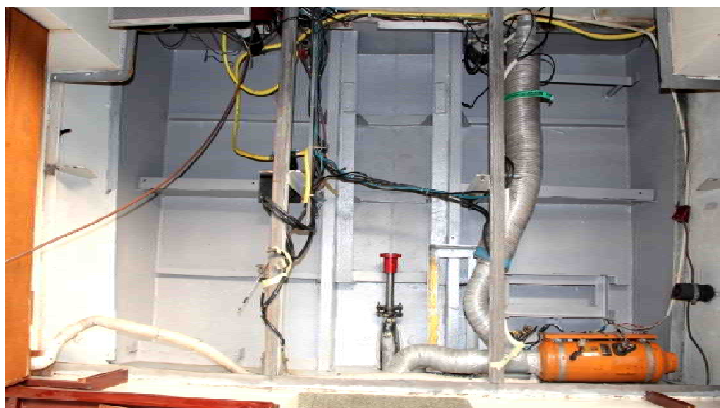
Het lege, in de epoxy gezette motorruim
