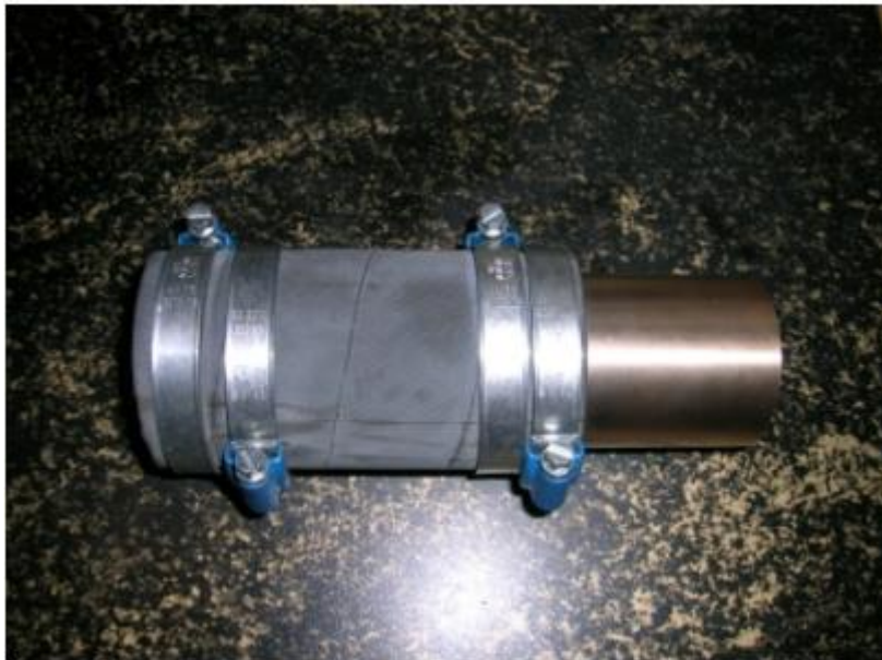
foto 4 aansluitmof gescheiden van een bronzen bus met keerringen
